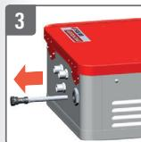
Filter entfernen und reinigenersetzen
