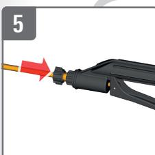
**Sprührohr an Handventil schrauben**
