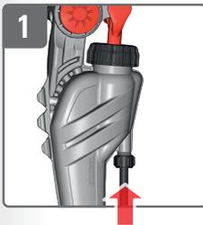
**Schlauch an Pumphebel schrauben**
