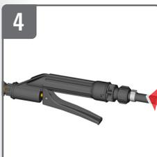
**Schlauch an Handventil schrauben**
