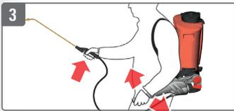
**Stetig leicht Pumpen – Sprühen**
